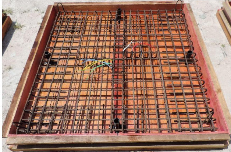
Figura 4.9 – Laje L1 com estribos perpendiculares
