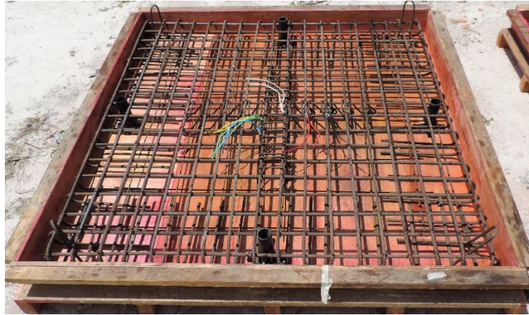
Figura 4.16 – Laje L2 com estribos inclinados
