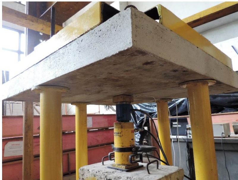
Figura 4.33 – Sistema de aplicação de carregamento no ensaio
