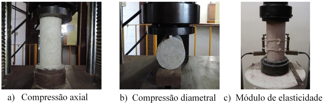
Figura 5.5 – Ensaio para determinação das propriedades mecânicas do concreto
