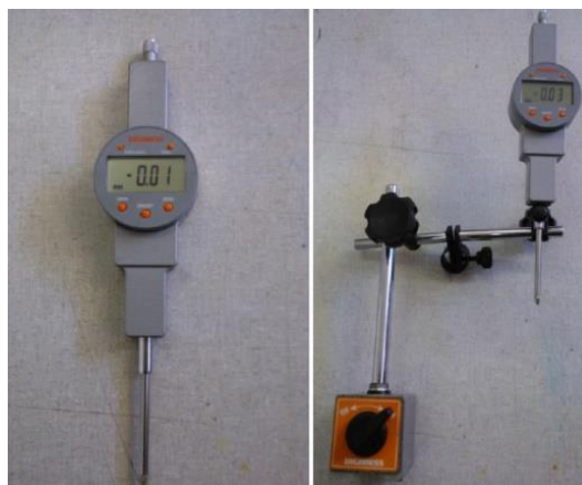
Figura 4.25 – Modelo de deflectômetro digital usado
