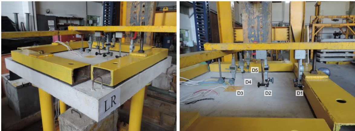
Figura 4.27 – Posicionamento dos defletômetros nos ensaios
