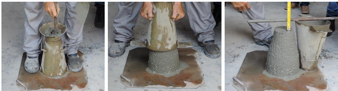
Figura 5.2 – Ensaio de abatimento do tronco de cone
